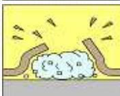
ドライアイスが気体に変化する時、その容積が700~800倍に膨張します。母材と剥離対象物の間に入ったドライアイスが膨張し、対象物を剥がしやすくなります。
